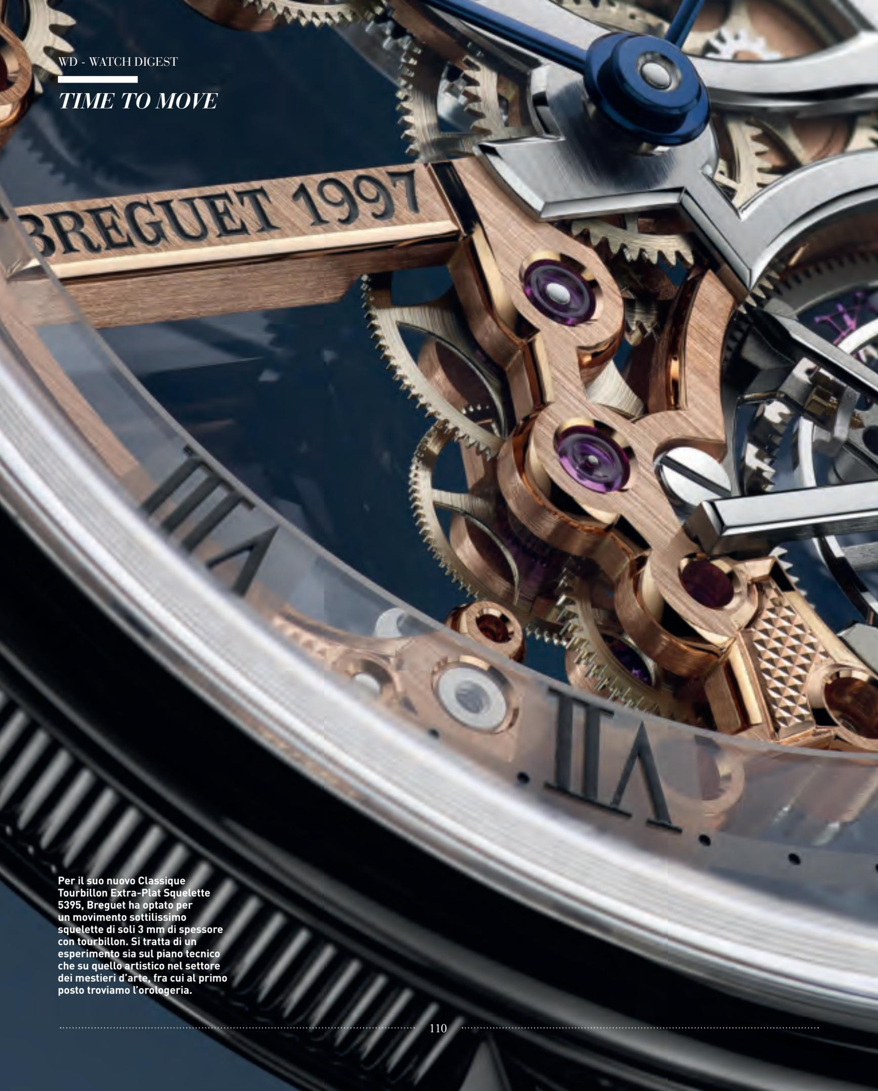
Per il suo nuovo Classique Tourbillon Extra-Plat Squelette 5395, Breguet ha optato per un movimento sottilissimo squelette di soli 3 mm di spessore con tourbillon. Si tratta di un esperimento sia sul piano tecnico che su quello artistico nel settore dei mestieri d'arte, fra cui al primo posto troviamo l'orologeria.
