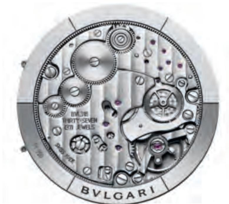
*Il movimento dell'Octo Finissimo Chronograph GMT meccanico di manifattura con carica automatica (massa periferica) e piccoli secondi - calibro BVL 318 (spessore 3,30mm). Riserva di carica di 55 ore; fuso orario locale regolato tramite il pulsante a ore 9*
